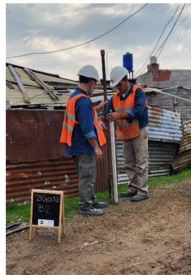
Los resultados sobre las capa de suelo limoso o limo arcilloso arrojan valores de CBR en función del DN (Índice de Penetración, mm/golpe, cantidad de milímetros penetrados por el aparato DCP respecto al número de golpes aplicados para una determinada energía entregada) en un rango que va de 5 % al 9 %. En el caso de las capas con escombros, el rango es muy disperso, en promedio en el orden del 2 al 20%.
