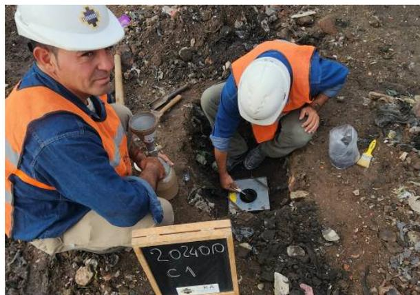
La densidad seca obtenida in situ a nivel de subrasante arrojó valores que oscilaron entre los 1,172 y 1,370 g/cm<sup>3</sup> hasta los 1,00 m de profundidad; mientras que los tenores de humedad oscilaron entre el 19,2 % y el 37,7 %.
