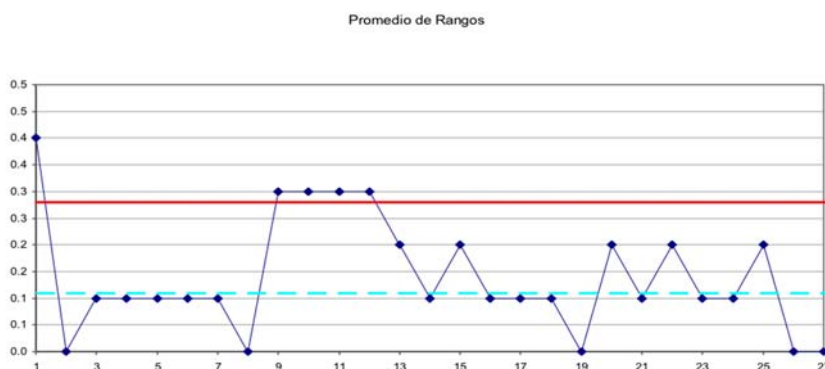
Gráfico 2. Promedio de Rangos (Valor Máximo – Valor Mínimo) para el Contenido de Asfalto Extraído de F10 de producción en Planta
