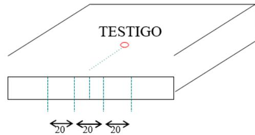
La determinación del espesor de un borde se efectuará sobre los puntos fijados en correspondencia con los testigos extraídos (Fig.2)
