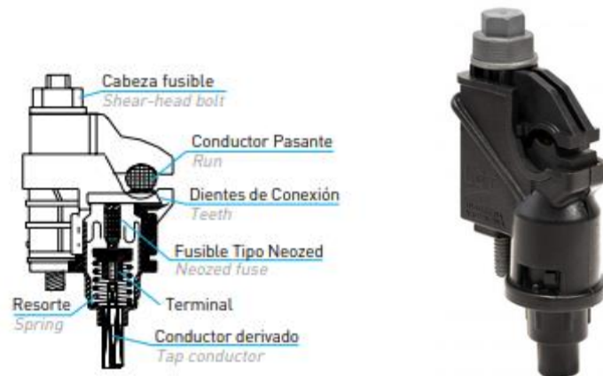
Imagen 13: Modelo de morsetería a implementar para conexión de la fase.
