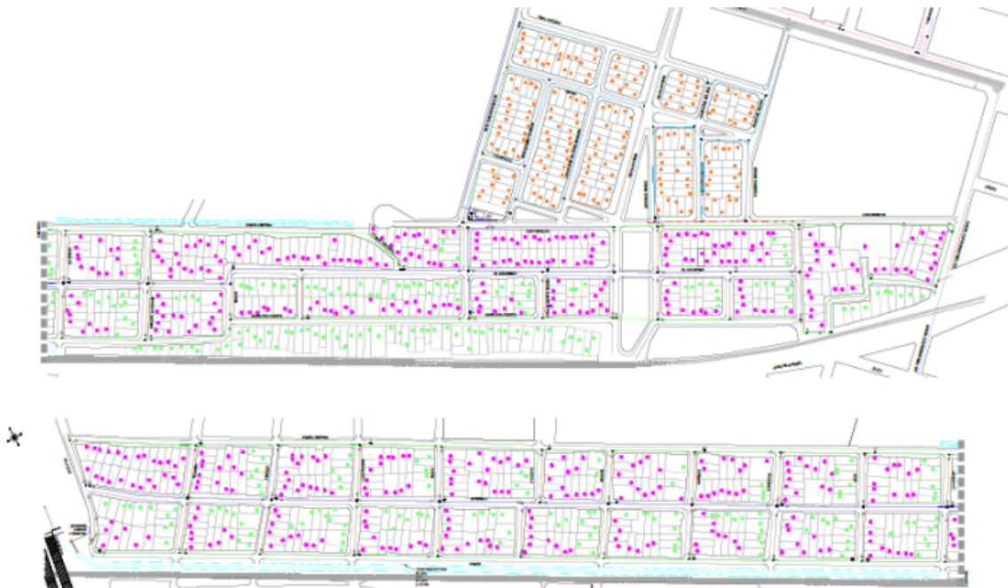
Figura N°2. Red de agua Tierras Argentinas.
