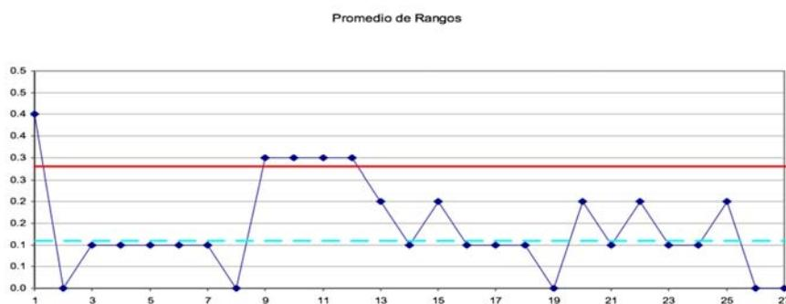
Gráfico 2. Promedio de Rangos (Valor Máximo – Valor Mínimo) para el Contenido de Asfalto Extraído de producción en Planta
