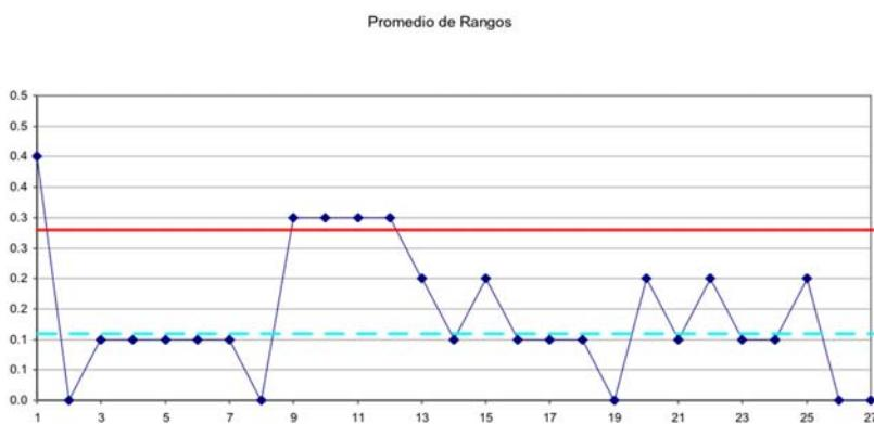
**Gráfico 2. Promedio de Rangos (Valor Máximo – Valor Mínimo) para el Contenido de Asfalto Extraído de F10 de producción en Planta**
