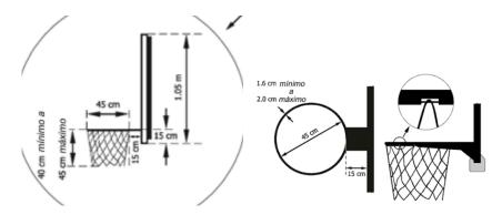
Nota: Todos los elementos metálicos tendrán un tratamiento anticorrosión cincado y serán pintados con pintura epoxi horneada termosellada.
